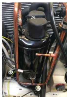
Figura 19 – Posizione del compressore
