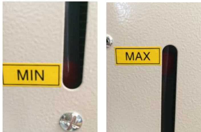
Abbildung 13/14 – Füllen des Tanks
