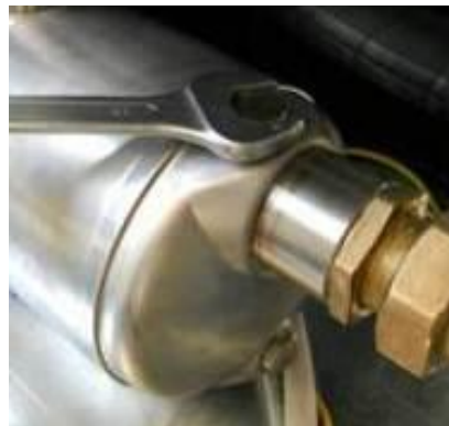
Figura 15 – Purgado de la bomba
