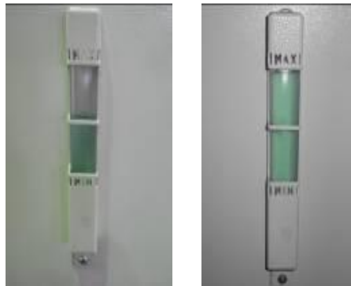
Figure 18 / 19 – Recharge du réservoir
