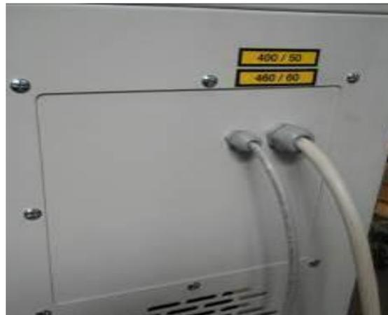
Рис. 4 - Планка для электр.подключения
