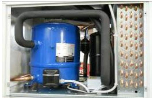
Figure 22 – Position du compresseur
