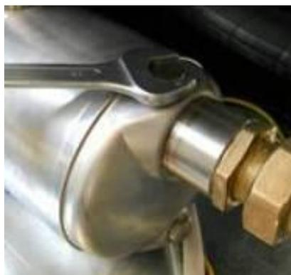
Figura 15 – Spurgo della pompa
