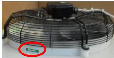
**Abbildung 21 – Drehrichtung des Lüfters**
