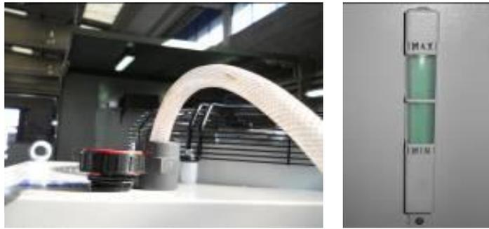
Figura 11 / 12 – Procedimiento de llenado y nivel
