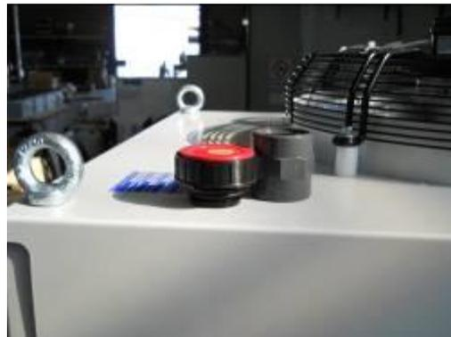
**Abbildung 10 – Befüllstutzen**
