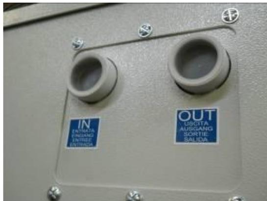
Abbildung 3 – Platte für Hydraulikanschlüsse
