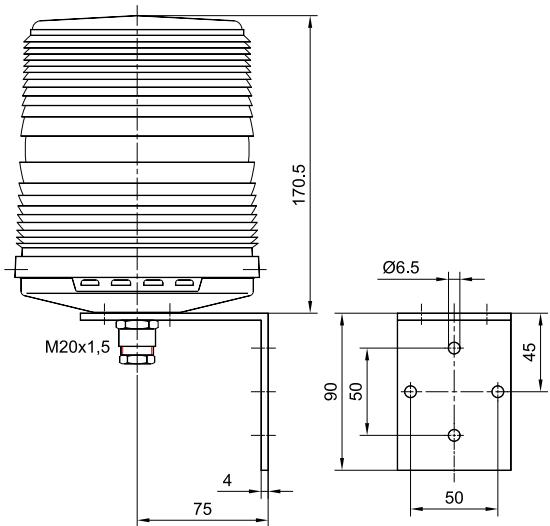
Die Befestigungsbohrungen können dem Bohrbild entnommen werden.
