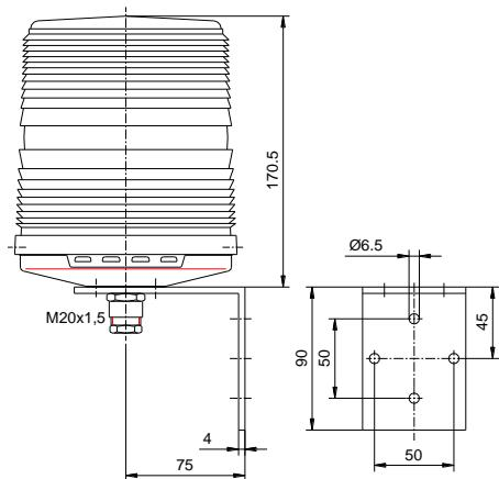
Die Befestigungsbohrungen können dem Bohrbild entnommen werden.
